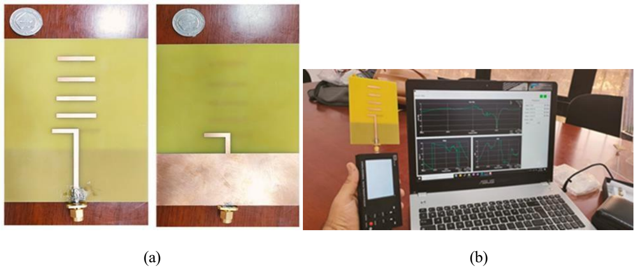
Figure IV.2: Antenne Yagi imprimée fabriquée, (a) antenne prototype, (b) mesure de l'antenne en laboratoire
