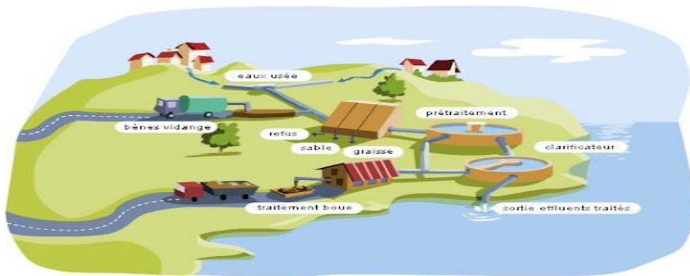
Figure 2 : Schéma d'une station d'épuration / assainissement collectif
