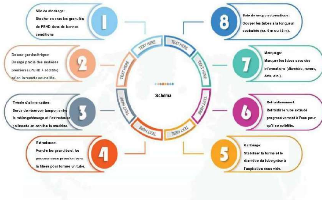
Figure II.4 : Machine utilisée et étapes de production (Ligne d'extrusion pour Tubes à simple paroi).
