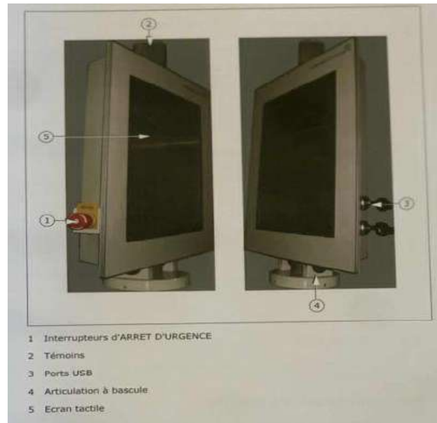
Figure III.14 : Vue d'ensemble du terminal.
