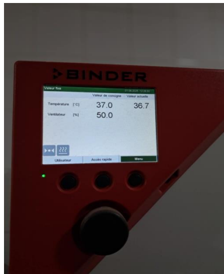
Figure 23 etuve de marque BINDER utilisée pour l'incubation des milieux de culture à température contrôlée
