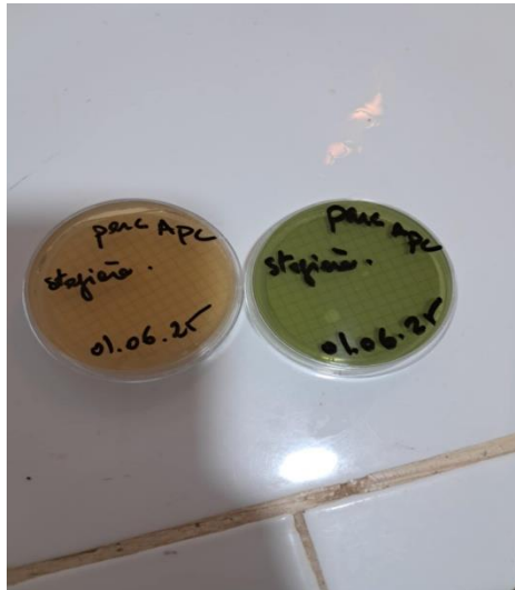
Figure 24 boîtes de pétri identifiées contenant les milieux spécifique pour la recherche des coliformes fécaux et des streptocoques fécaux
