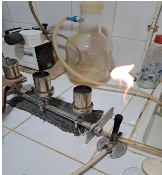
Figure 20 Système de filtration sous vide utilisé pour l'analyse microbiologique des eaux (coliformes et streptocoques)
