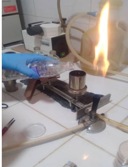
Figure 25 Etape de filtration d'eau à l'aide du système de filtration sur membrane
