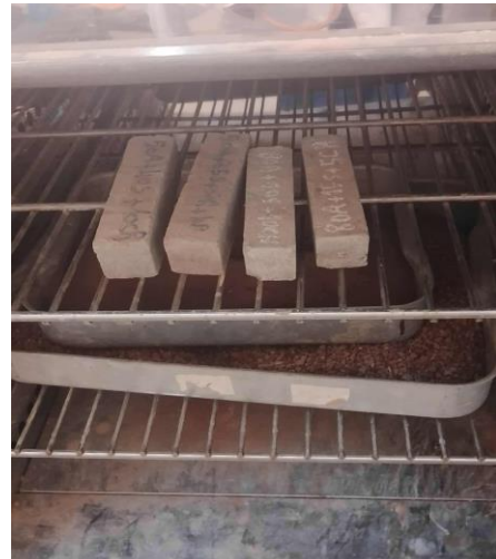
Figure III.8 : Les mortiers dans l'étuve
