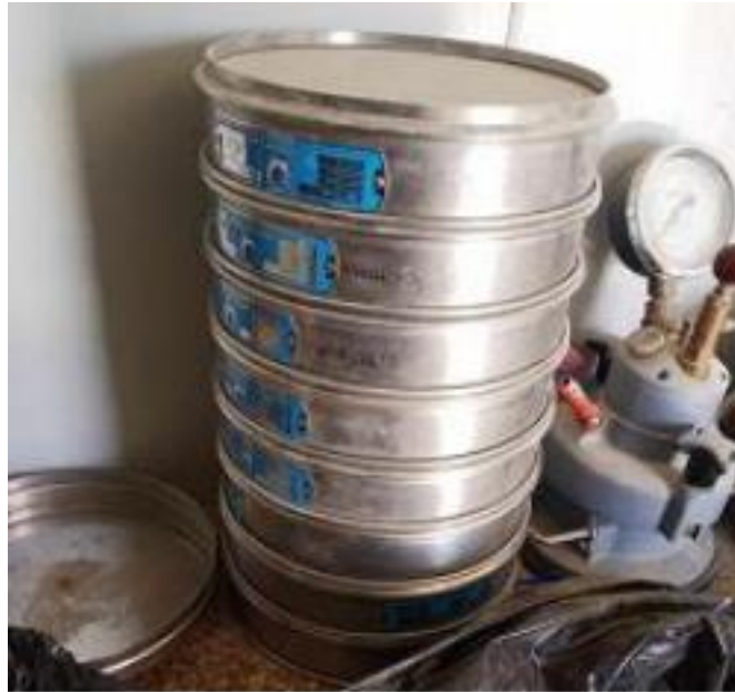
Fig II.15 : Série de tamis de l'analyse granulométrique pour le sable
