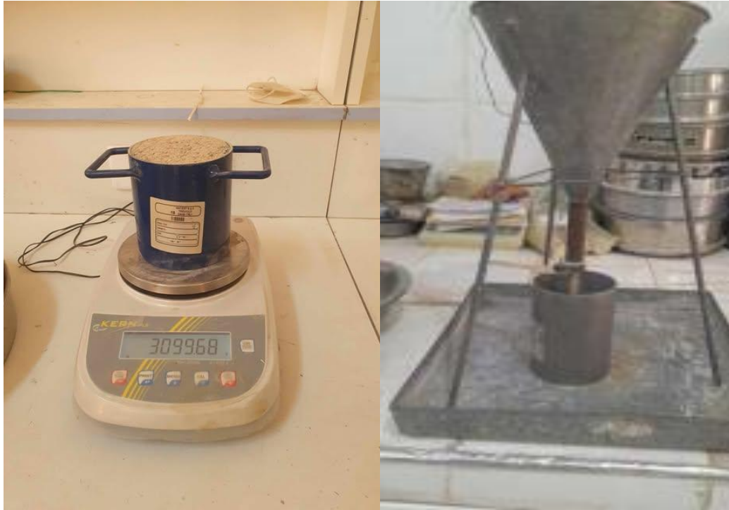
Fig II.18 : Détermination de la masse volumique apparente du sable
