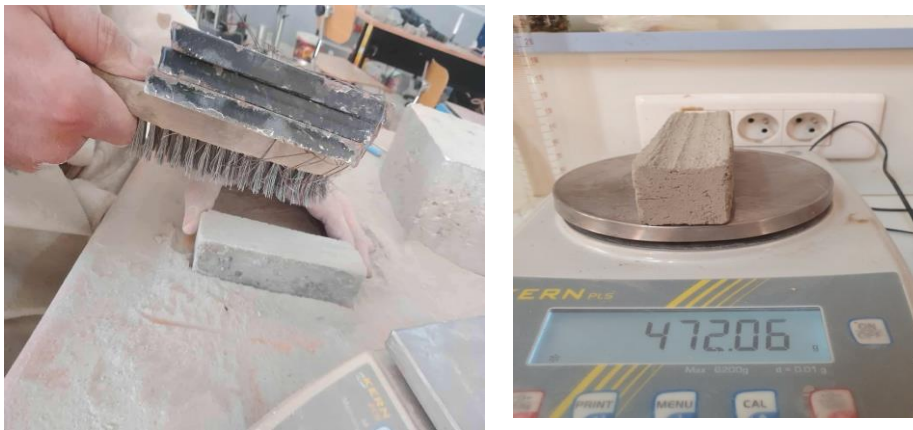
Figure III.13: Essai de Résistance à l'abrasion
