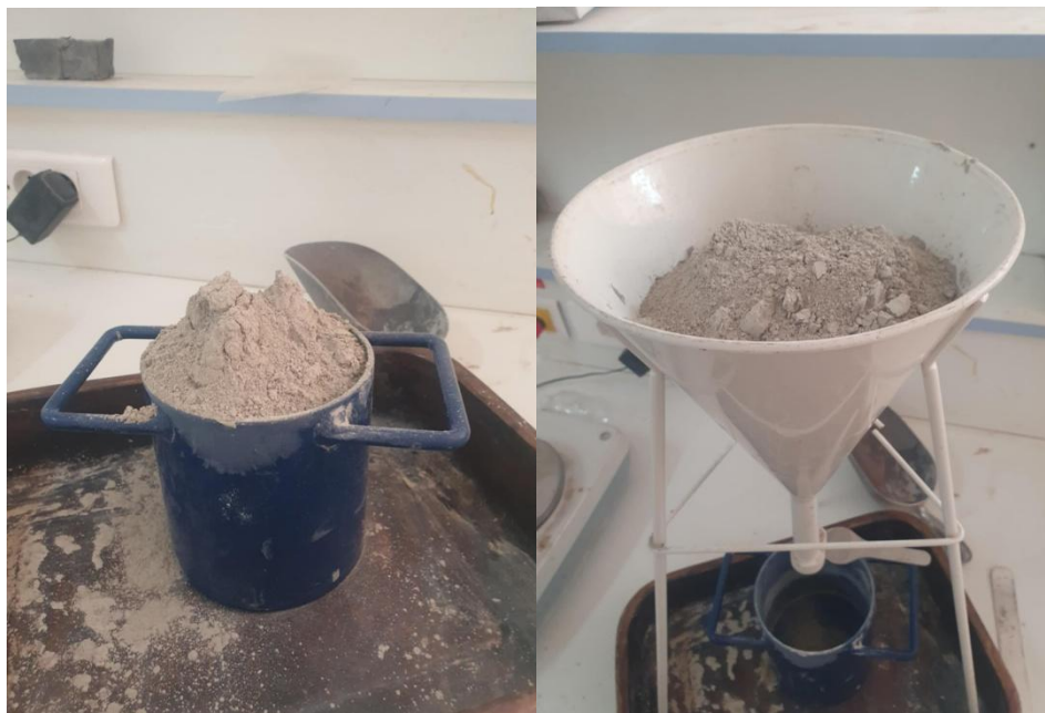
Fig II.13 : Détermination de la masse volumique apparente de l'argile
