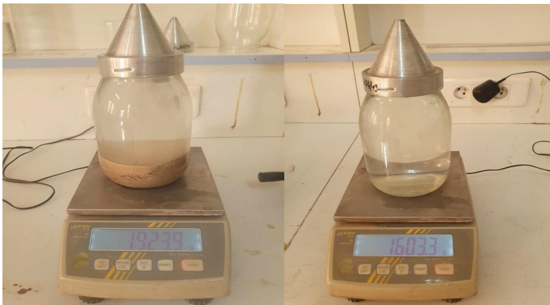
Fig II.17 : Détermination de la masse volumique des grains solides pour le sable
