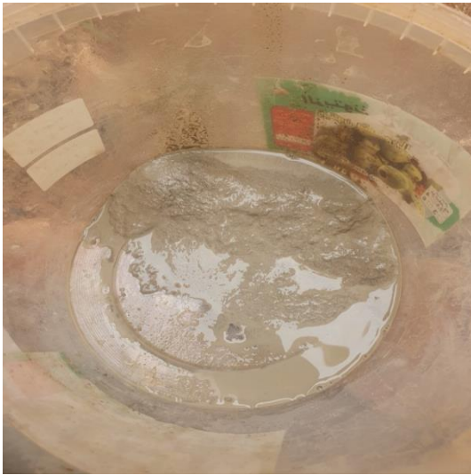
Figure III.18: Essai Absorption totale pour la formulation 0% ajout et la formulation 5% chaux
