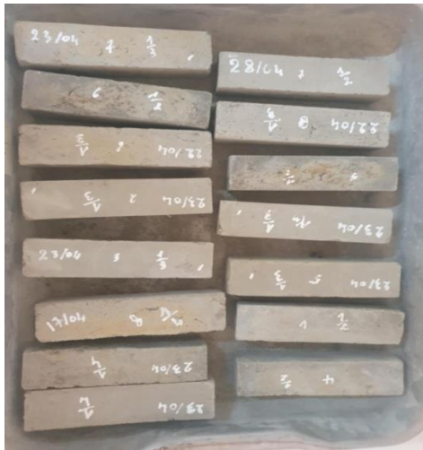
Figure III.7: Eprouvettes démoulés et stockés à l'air libre
