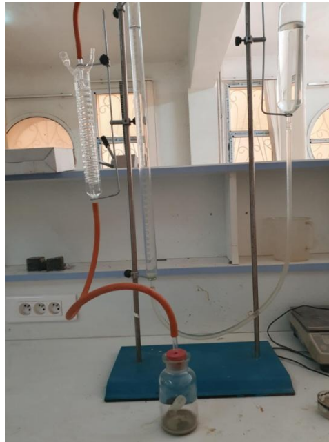
Fig II.14 : Détermination de la teneur en carbonate de calcium dans l'argile
