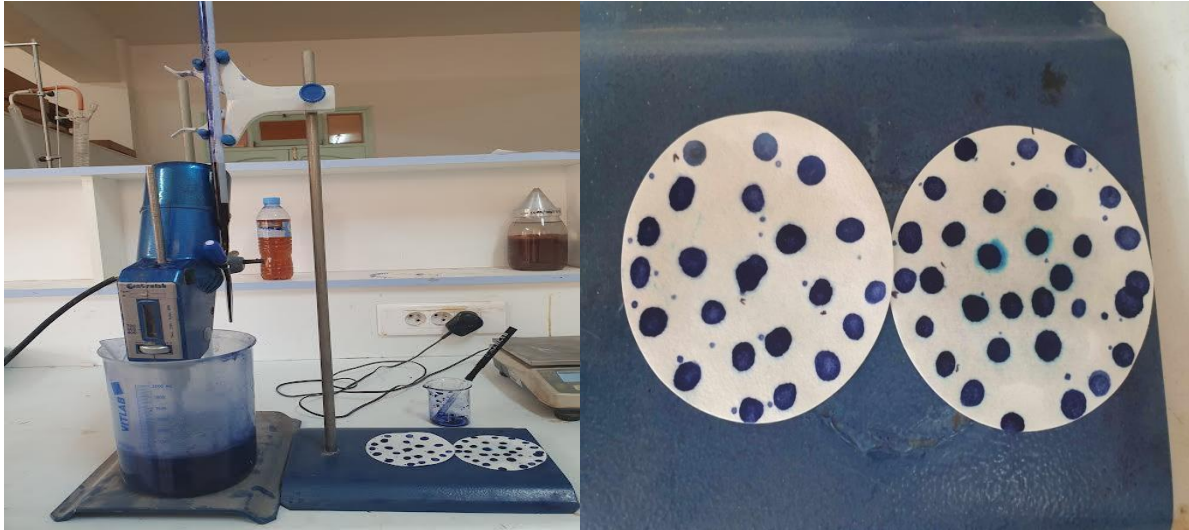
Figure II.11 : Essai au bleu de méthylène pour l'argile (UBBAT)
