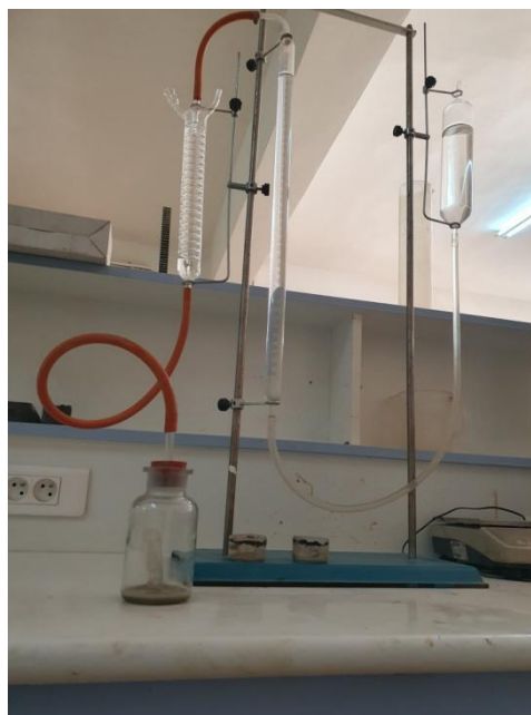
Fig II.21 : Détermination de la teneur en carbonate de calcium dans le sable
