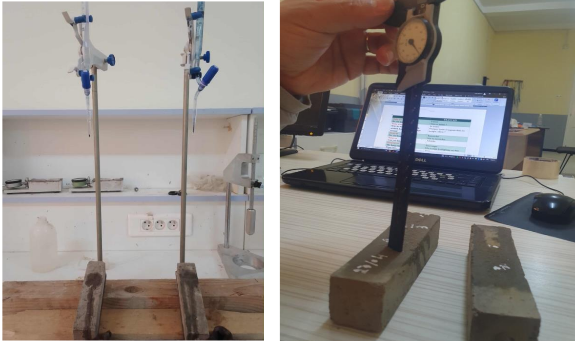
Figure III.12 : Essai de résistance à l'érosion (L'essai de goutte -a-goutte)
