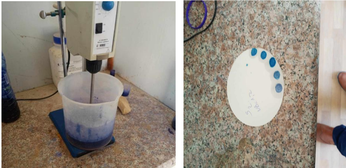
Fig II.19: Essai au bleu de méthylène pour le sable (GICA Ain Temouchent)
