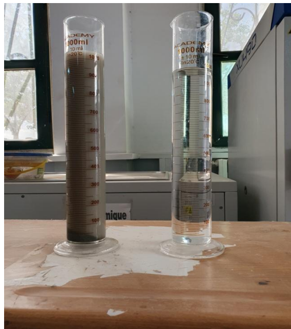
Fig II.6 : Essai de sédimentométrie pour l'argile (UBBAT)
