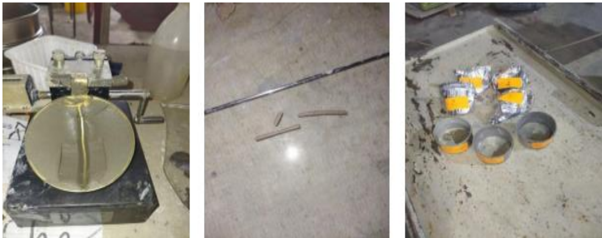
Fig II.8: Essai de limites d'Atterberg (UBBAT)
