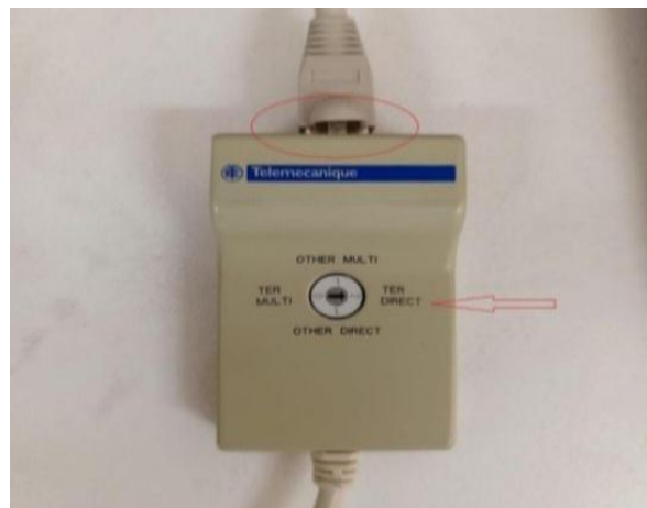
Figure III.6 : Connecteur TER et adaptateur de communication série RS-485 [35]
