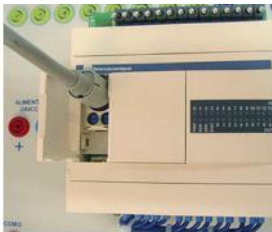
Figure III.6 : Connecteur TER et adaptateur de communication série RS-485 [35]
