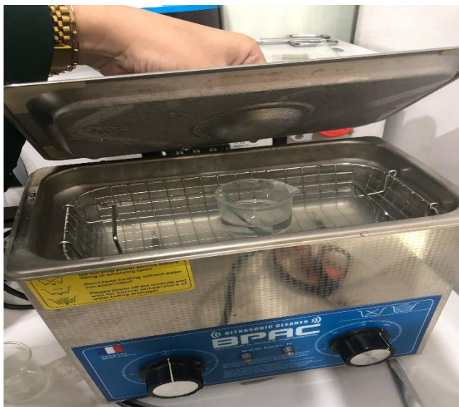
Figure III.2 : Équipement à ultrasons pour la préparation des solutions
