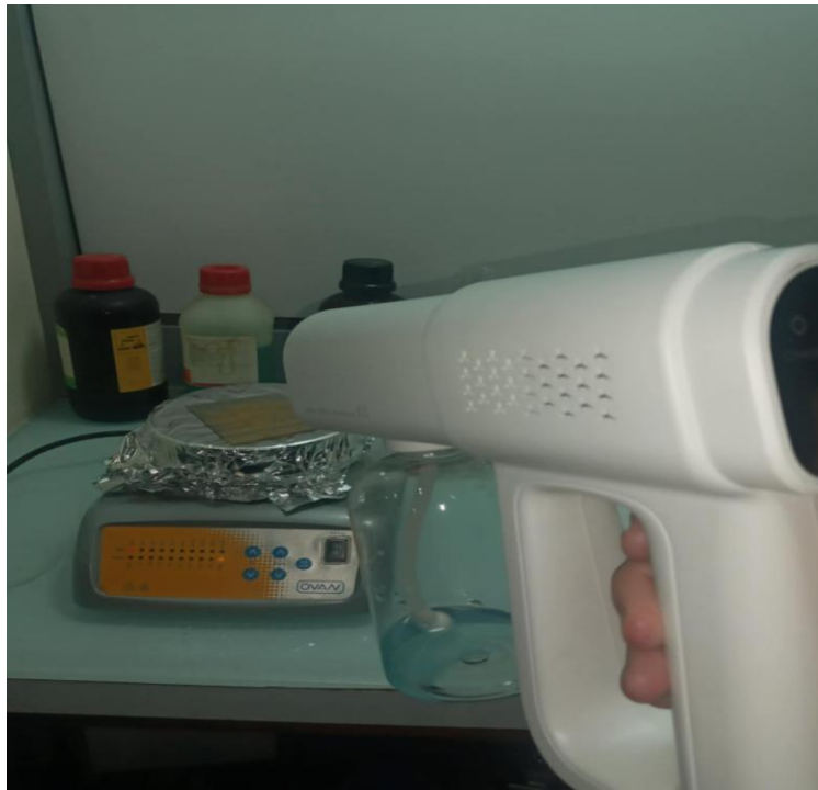
Figure II.5 : méthode de spray pyrolyse (pistolet)
