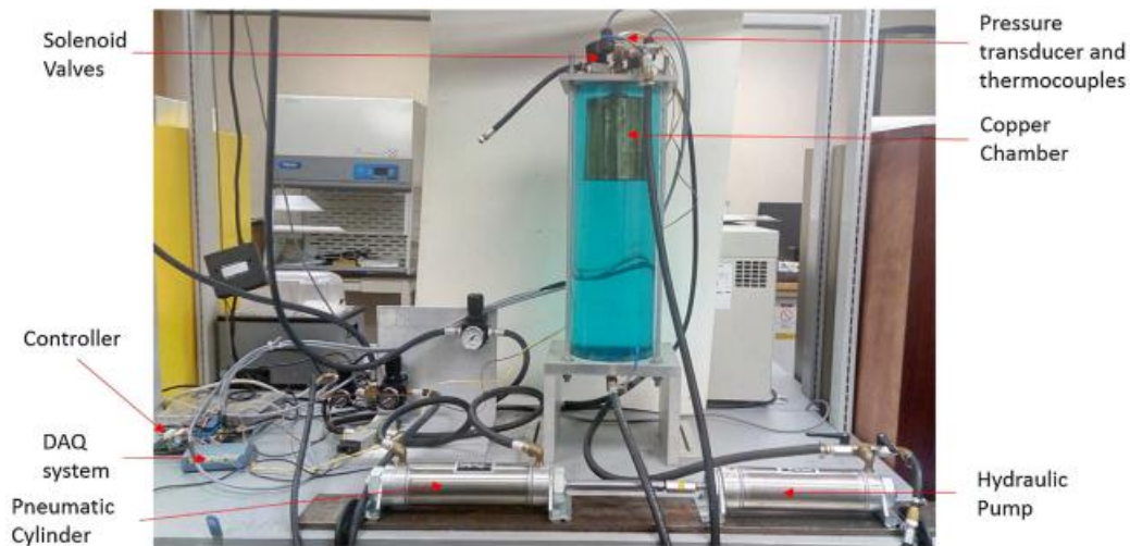
Figure I-05 : Le dispositif expérimental mis en œuvre pour le compresseur à piston liquide [21].
