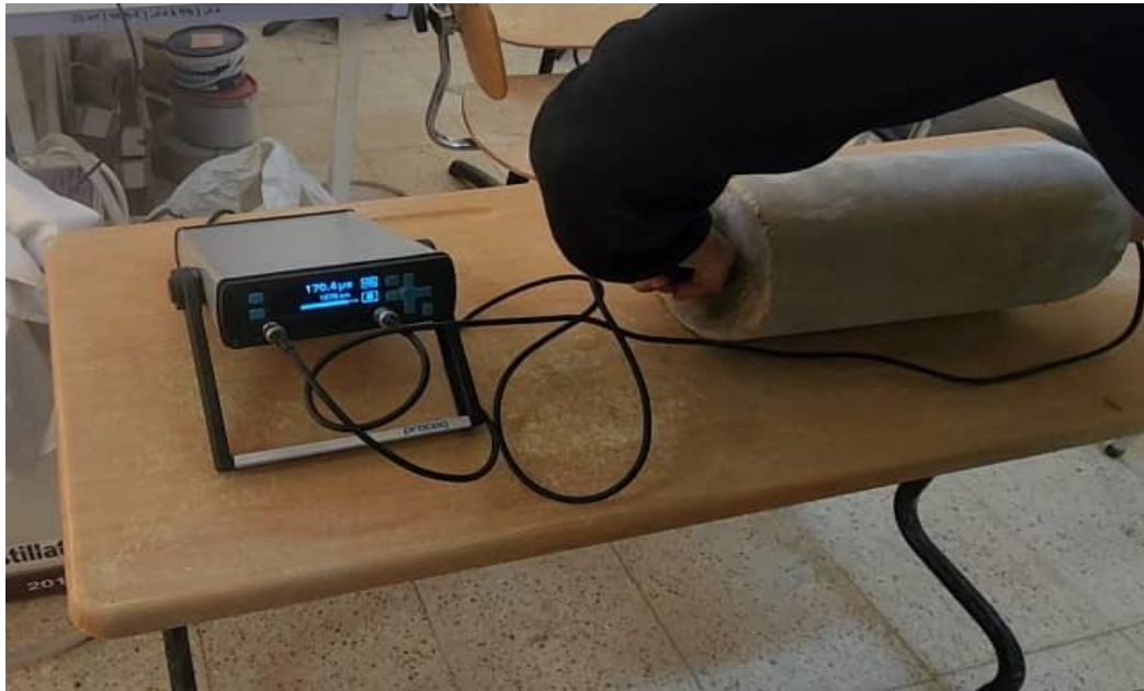
Figure 47 : Un test sur la résistance phonique sur l'un des éprouvettes
