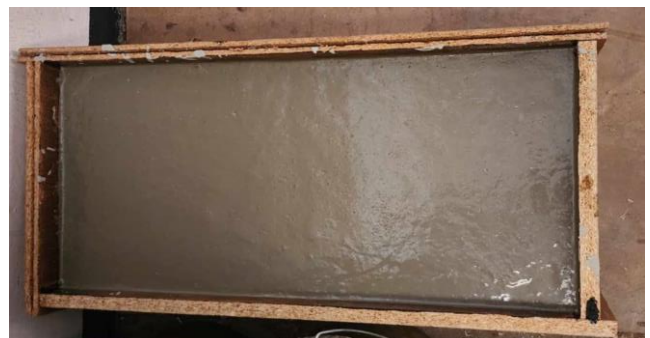
Figure 41 : Coulage du mélange dans le moule
