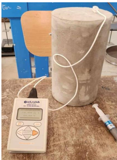
Figure 45 : Un test sur la conductivité thermique sur l'un des éprouvettes
