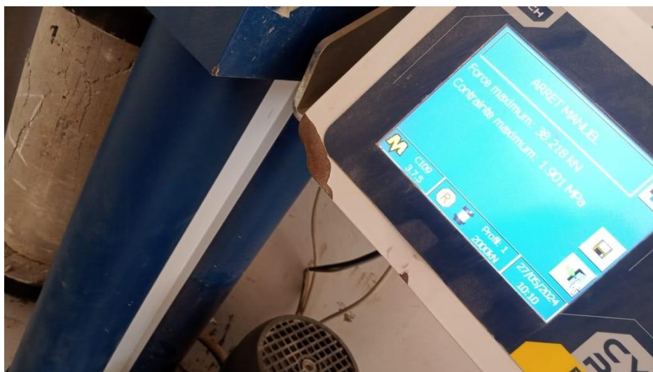
Figure 46: Un test sur la résistance mécanique sur l'un des éprouvettes
