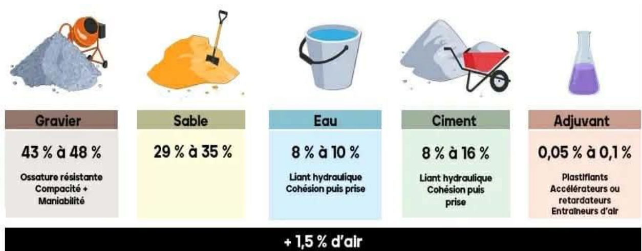
figure-2-4 : les composants du béton
