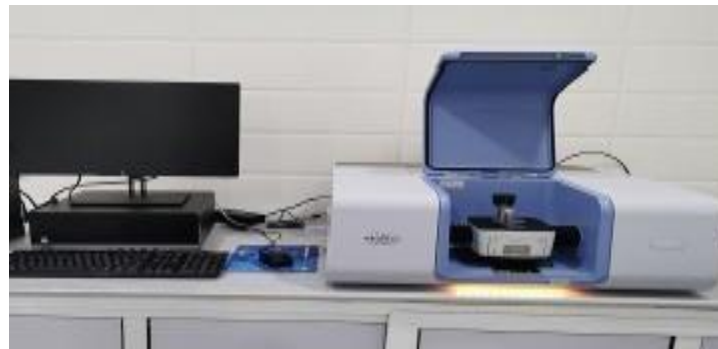
Figure10 : Un spectrophotomètre infrarouge [59]
