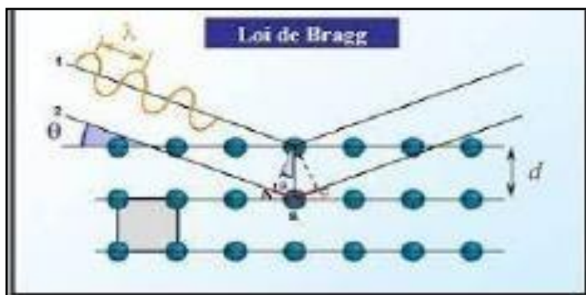
Figure13: Un schéma de principe de la diffraction des rayons X [62]
