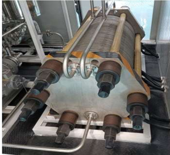
Figure (I.7) : Electrolyseur alcalin[10]
