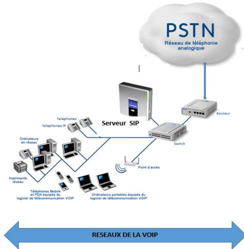
Figure III.42 : Architecture d'interconnexion entre le réseau RTC et le réseau VoIP basée sur un serveur Asterisk (SIP).
