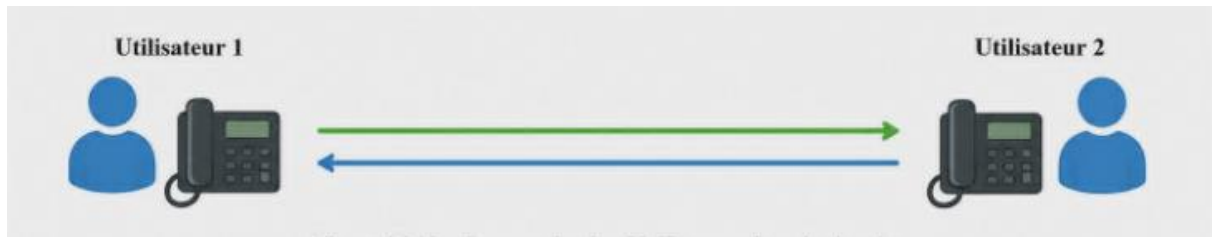
Figure II.7 : Mode point à point.
