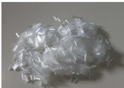
Fig.II- 16: La géométrie de fibres polypropylène utilisées
