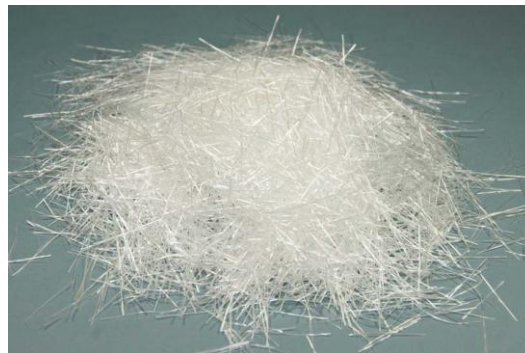
Fig.II- 17: La géométrie de fibres verre utilisées
