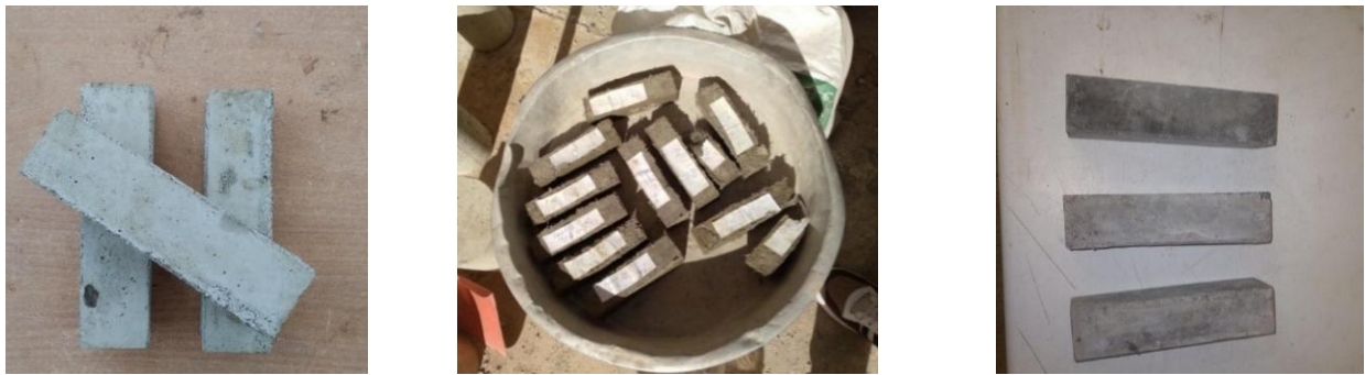
Fig.III- 6 : Préparations des éprouvettes des mortiers
