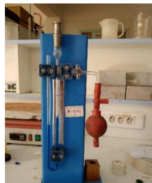
Fig.II- 12:l'appareille de Blaine
