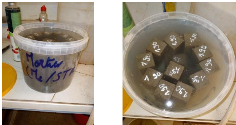
Fig.III- 6 : Préparations des éprouvettes des mortiers
