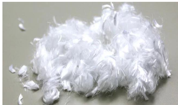
Fig. I 2: fibres de polypropylène [15]
