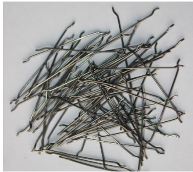
Fig.II- 15: La géométrie de fibres métalliques utilisées
