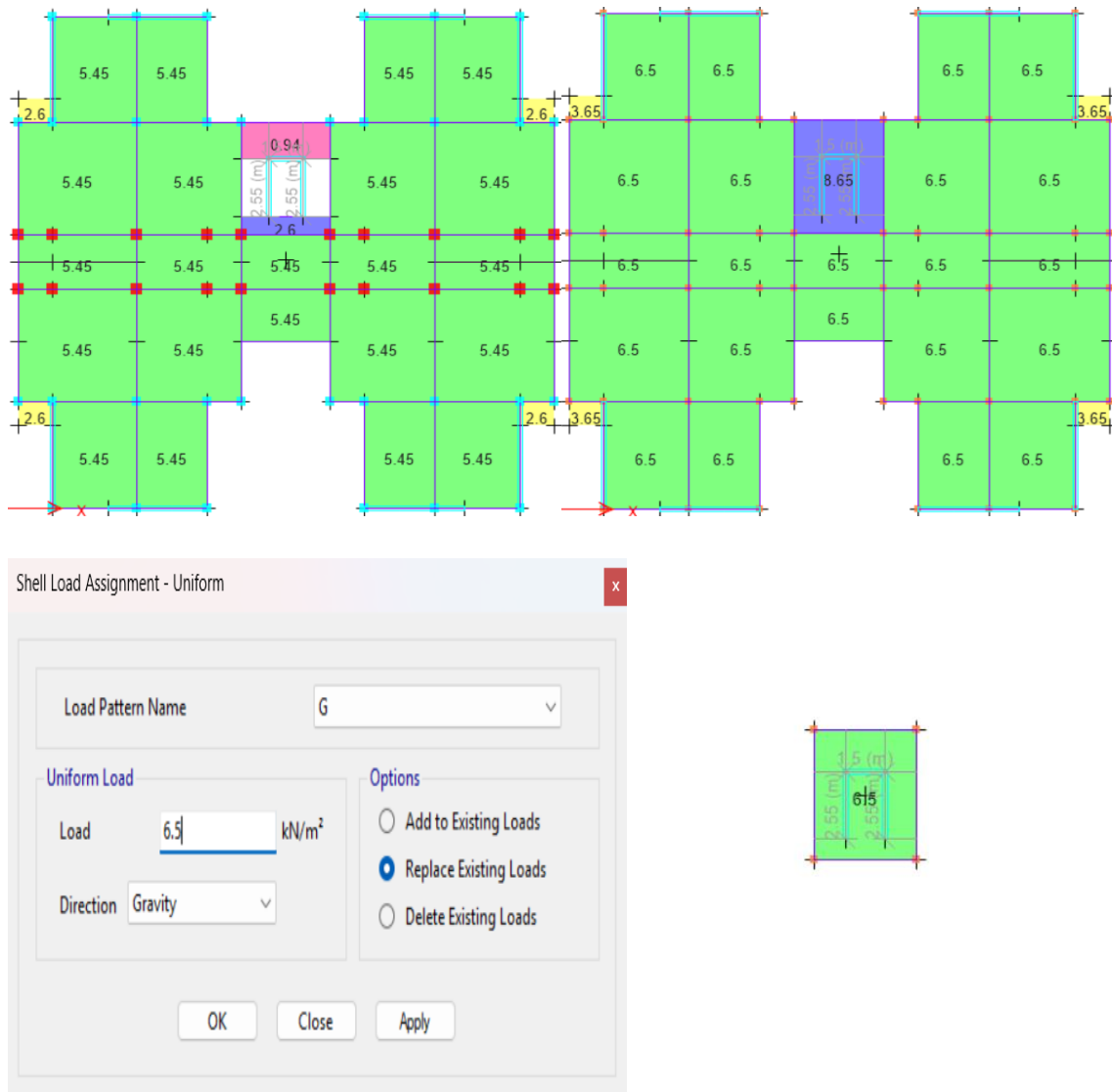
Figure 7.8 — modélisation des charges permanentes sur etabs
