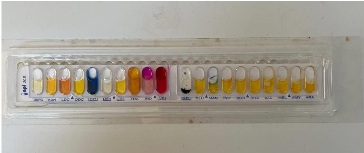
Figure 23: Résultat des tests biochimiques sur galerie API20E pour l'identification d' Escherichia coli (Photo prise par GUERMOUCHE et GUEDIM, 2025).
