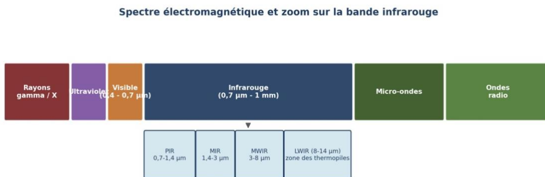
Figure 1.2: Spectre électromagnétique et zoom sur la bande infrarouge
