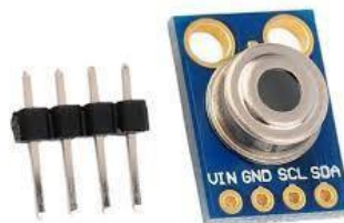
Figure 2.2 : Image réelle d'un capteur MLX90614
