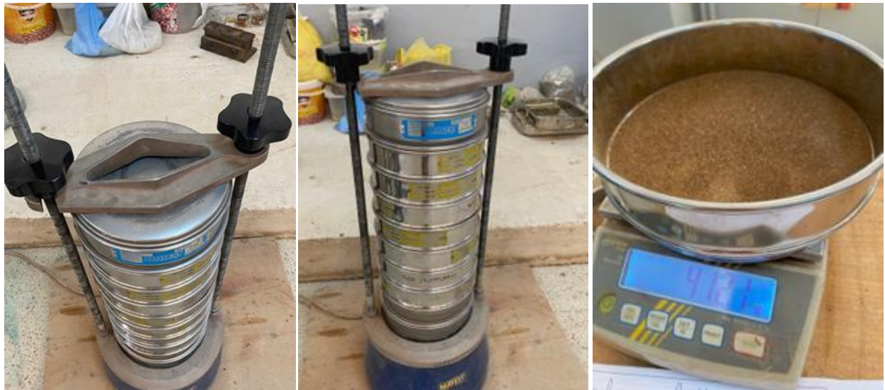
Figure 08 : Illustrant les étapes de manipulations de l'analyse granulométrique effectuées au laboratoire de génie civile (Belkadi, A. N., 2026).
