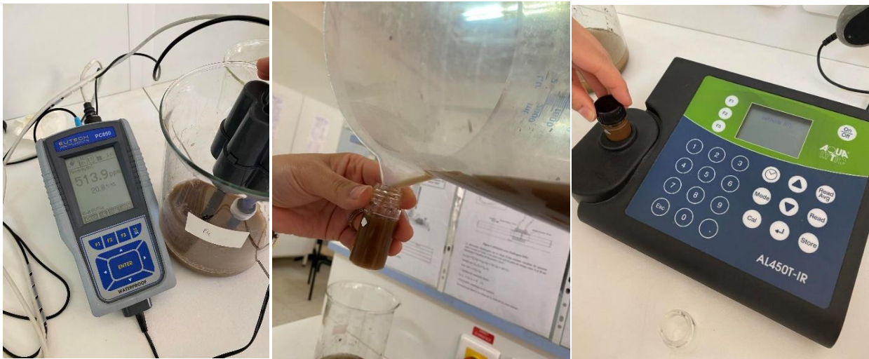
Figure 14 : Illustrant les étapes de manipulations d'évaluation du couple (Sels dissous + Turbidité) au laboratoire d'hydraulique (Belkadi, A.N., 2026).
