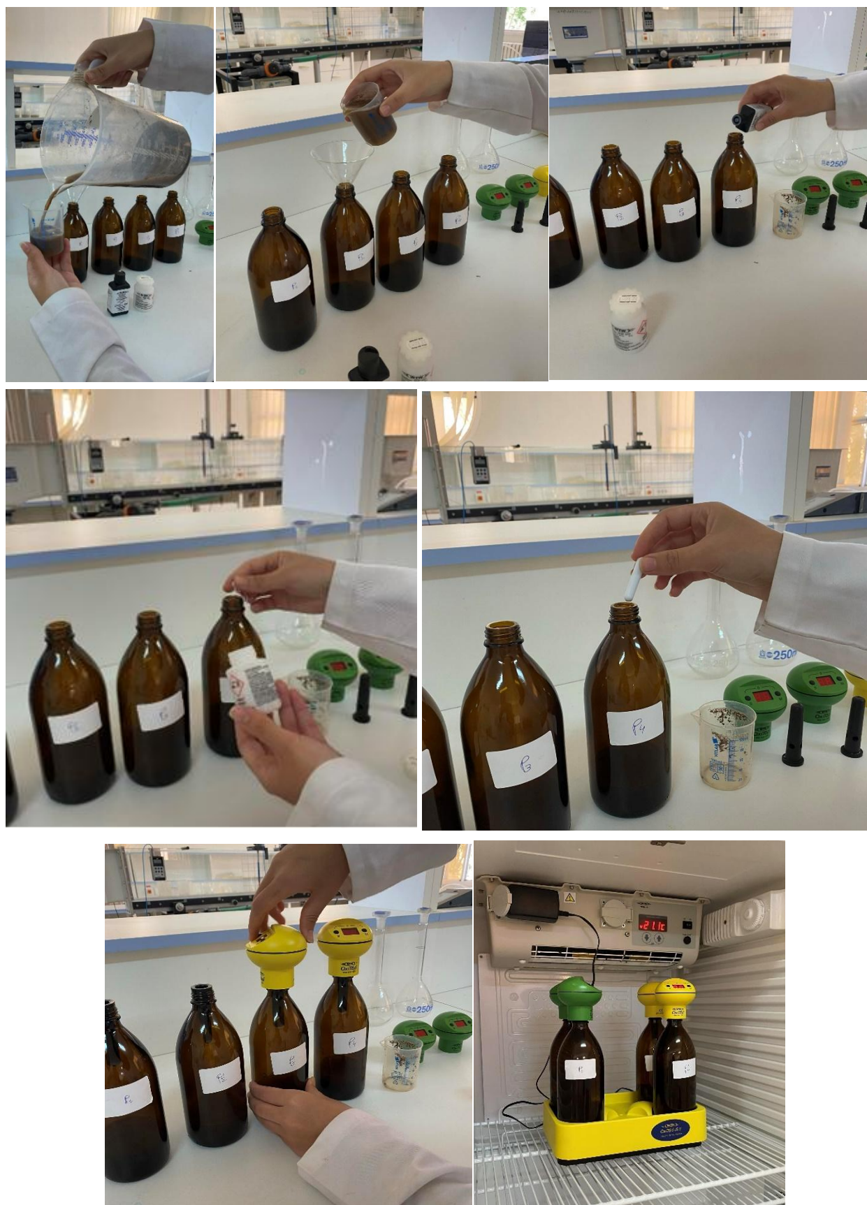
Figure 13 : Illustrant les étapes de manipulations d'évaluation de la stabilité structurale et de la cinétique de désagrégation des agrégats au laboratoire d'hydraulique (Belkadi, A.N., 2026).
