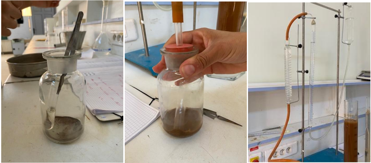
Figure 12 : Illustrant les étapes de manipulations de détermination du carbone et du calcium des sols effectuées au laboratoire de génie civile (Belkadi A. N., 2026).
