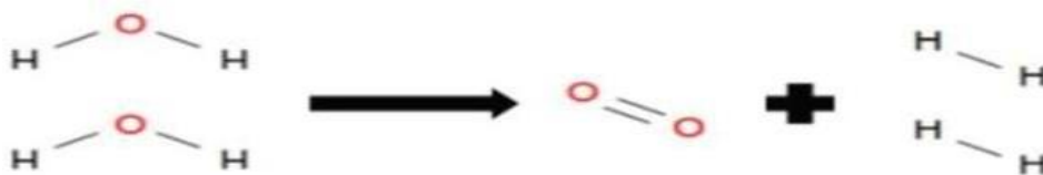
Figure(II.7): Principe de l'électrolyse de l'eau[1]
