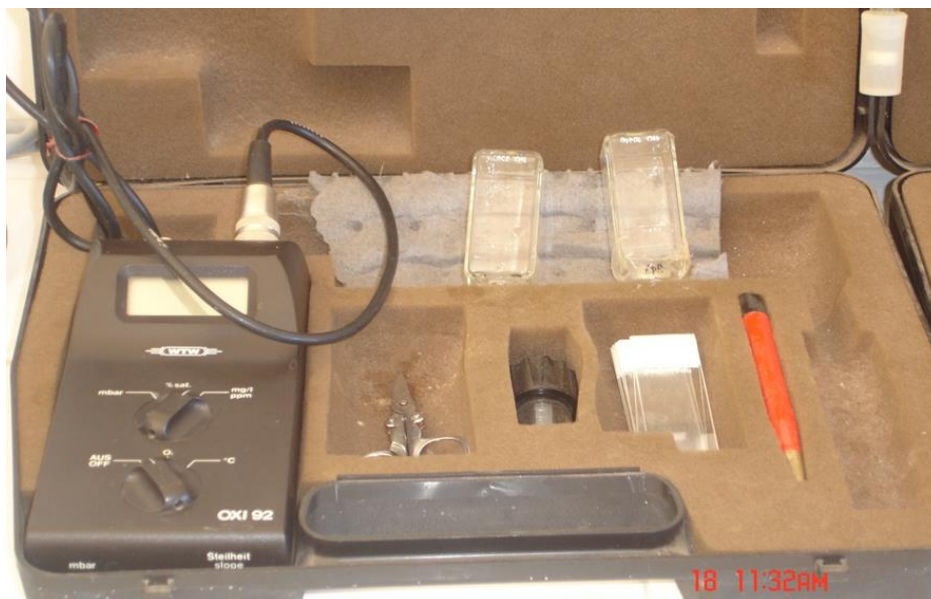
Fig. IV-4 photo d'un oxymètre portable modèle OXI 92 WTW. [59]
