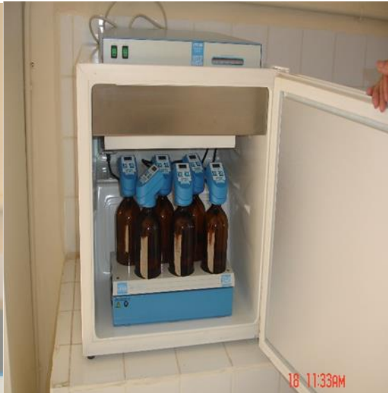
Fig. IV-18 photo d'un flacon à D.B.O. [59] Fig. IV-19 photo d'un D.B.O mètre. [59]
