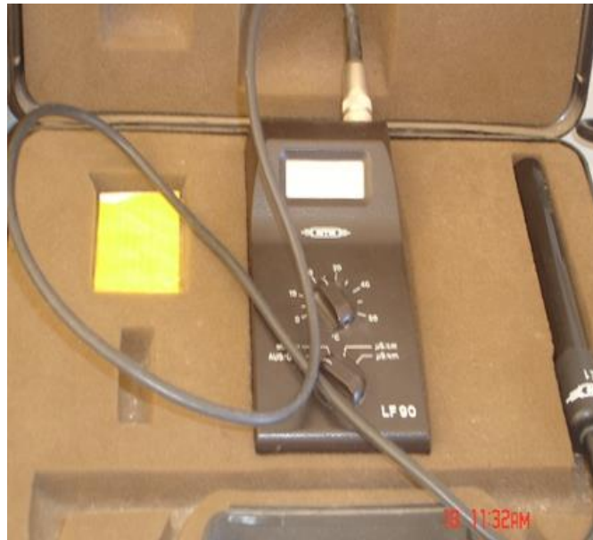
Fig. IV-6 photo d'un conductimètre portatif modèle LF 90 WTW [59].
