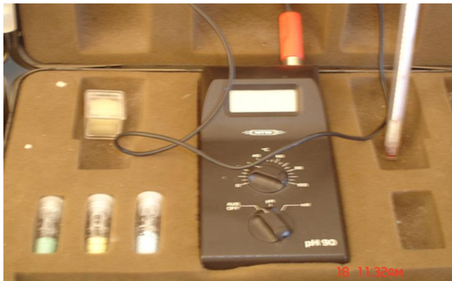
Fig. IV-2 photo d'un pH-mètre portatif modèle pH 90 WTW [59].
