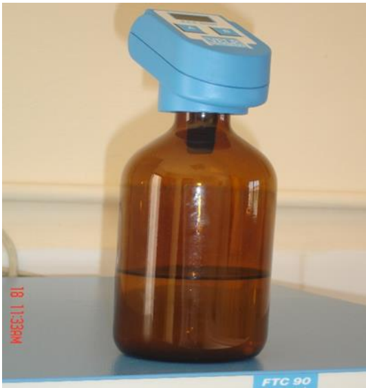
Fig. IV-18 photo d'un flacon à D.B.O. [59] Fig. IV-19 photo d'un D.B.O mètre. [59]
