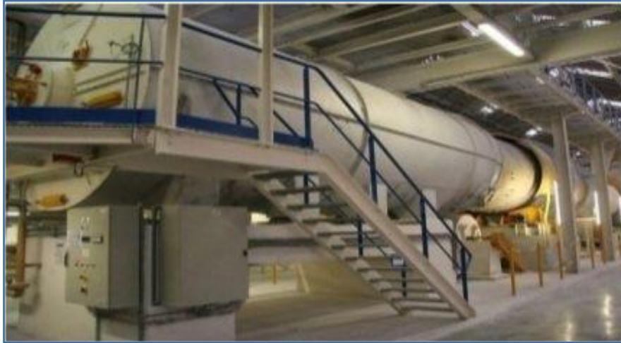
Figure 17: four de cuisson du gypse (Fethallah A. H., 2023)
