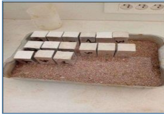
Figure 51 : Absorption d'eau par capillarité
