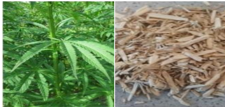
Figure 1 : granulats biosourcés à base de chanvre (abbas, 2021) (page & all, 2016)
