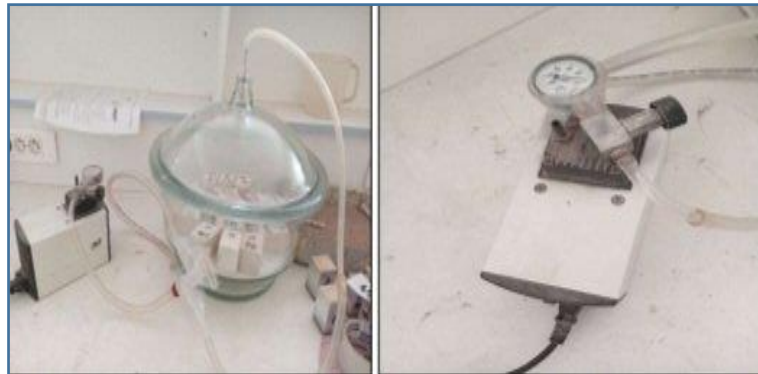
Figure 53: appareille porosité accessible à l'eau
