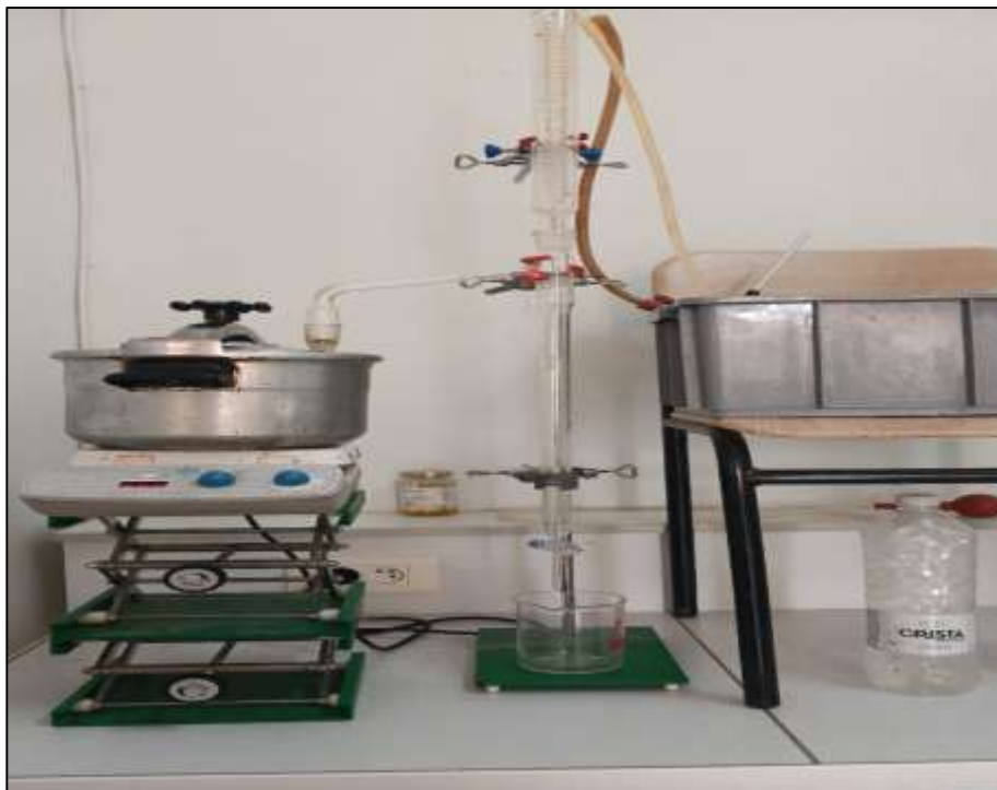
Figure_25: Dispositif utilise pour l'extraction des HEs.
