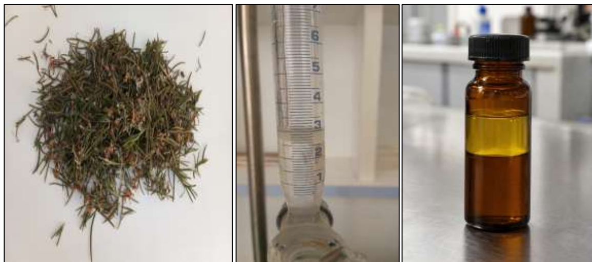
Figure_26 : Séparation des HEs par décantation
