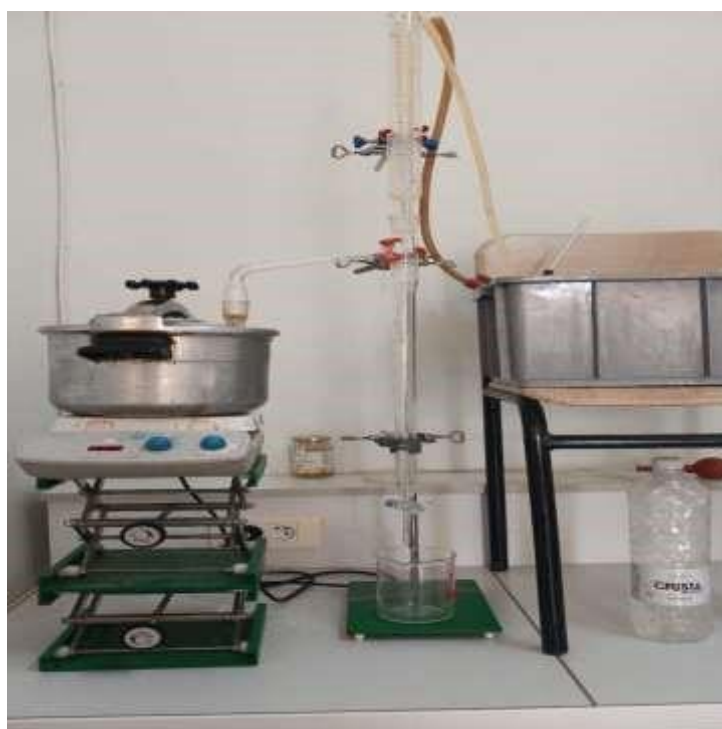
Figure_23: Dispositif utilise pour l'extraction des HEs.
