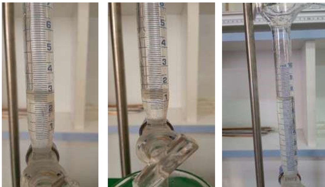
Figure_24 : Séparation des HEs par décantation
