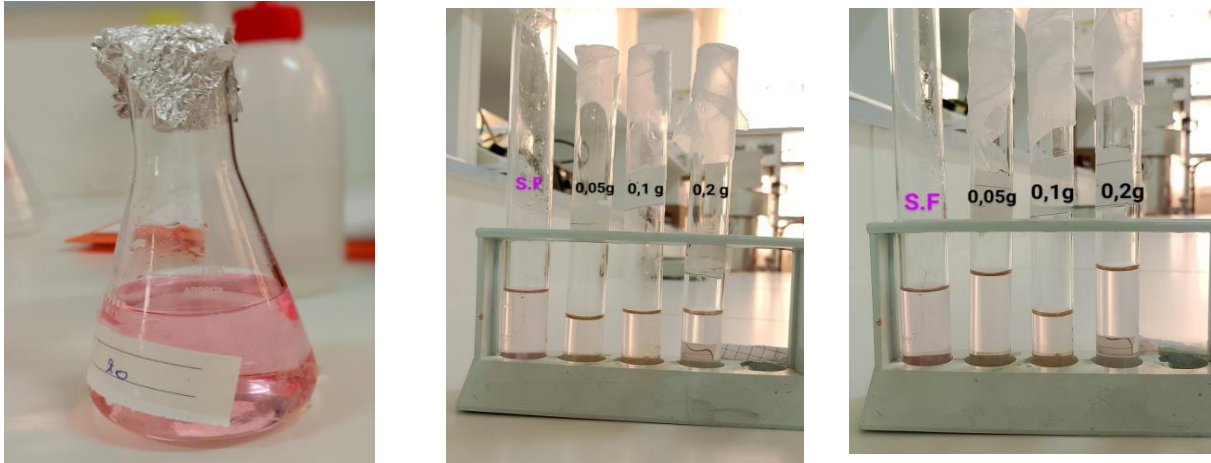
Figure III-18: a) Solution fille à concentrations 20 g/L, b) Adsorption du colorant azorubine sur le charbon actif issu d'écorces de citron, c) Adsorption du colorant azorubine sur le charbon actif issu d'écorces d'orange.
