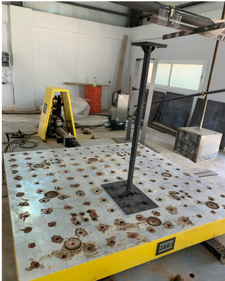
Figure 58 présentation du spécimen placé sur la table vibrante
