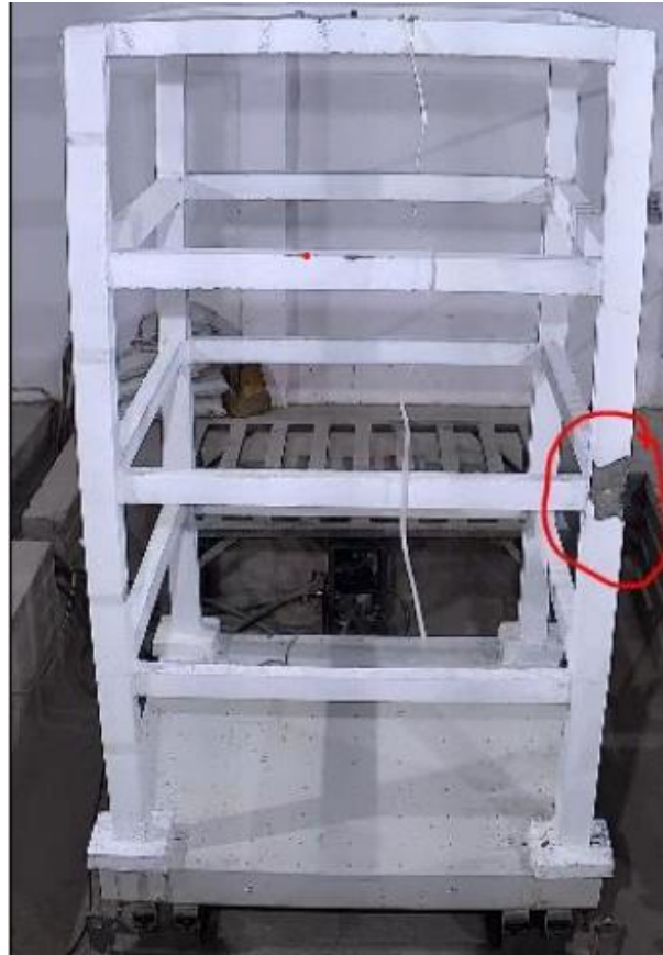
Figure 19 Fissures après le dernier cycle
