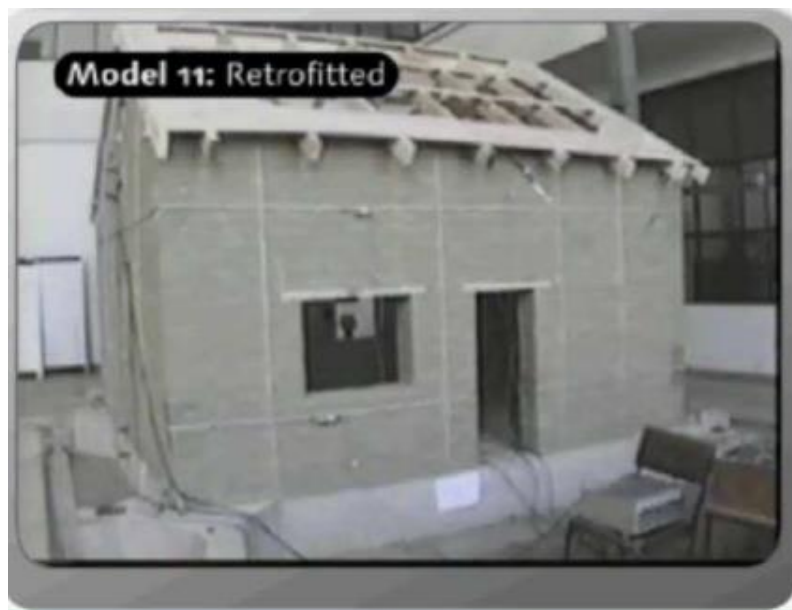
Figure 1 Essai sur table vibrante d'une maison en maçonnerie non chaînée
