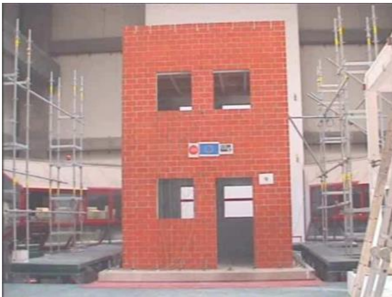
Figure 2 Essai sur table vibrante d'une maison en maçonnerie confinée
