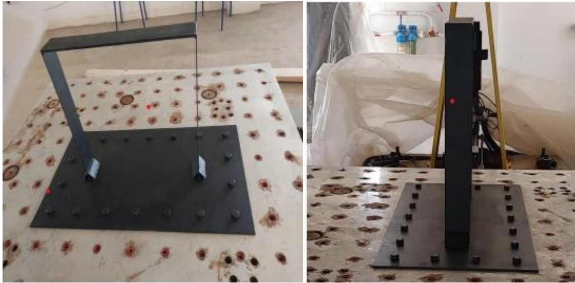
Figure 24 Photos du modèle réduit fixé sur la table de RISAM
