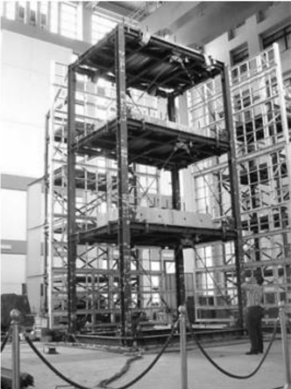
(a) Photos de la structure d'essai, avec l'amortisseur fixé.
