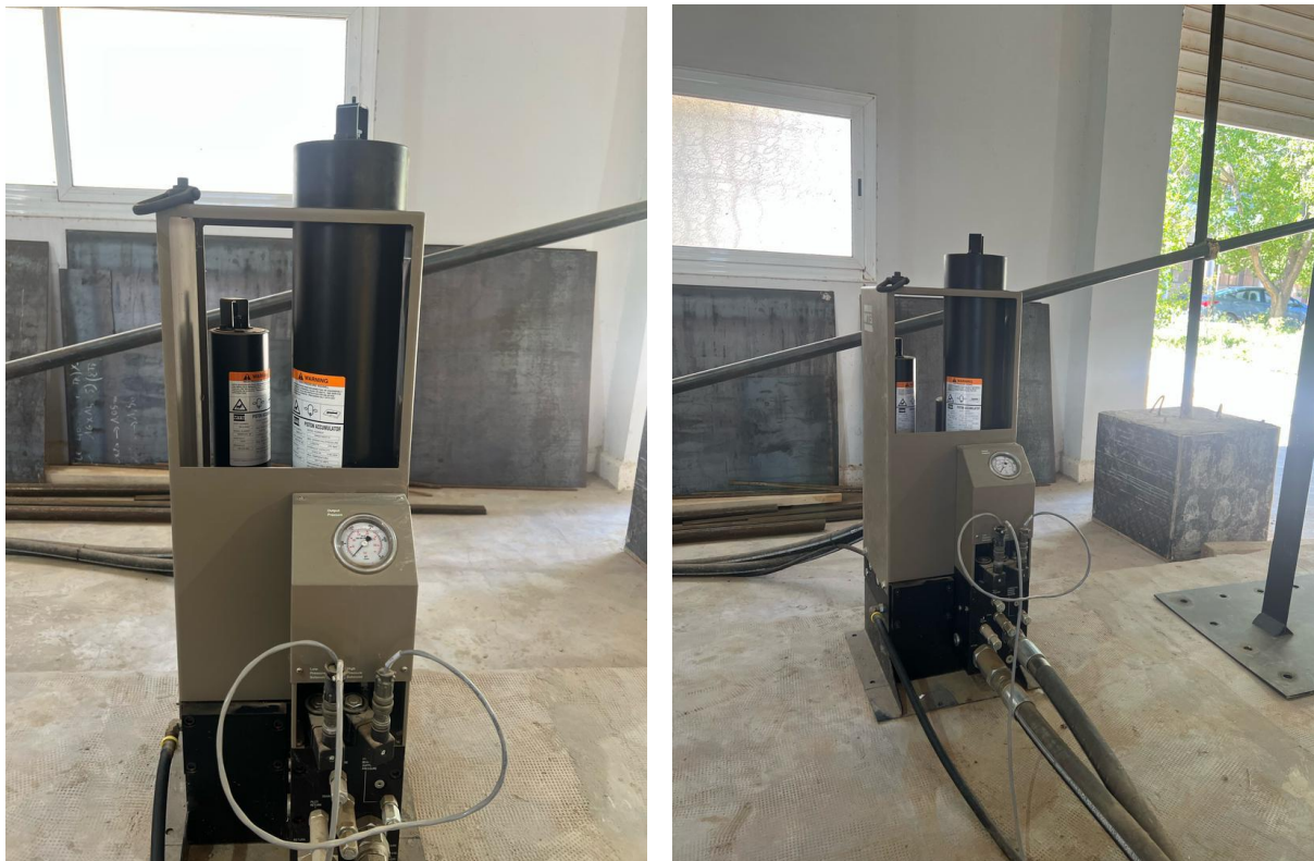
Figure 43 Le service hydraulique collecteur (HSM) de la table vibrante de RISAM
