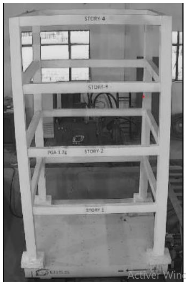
Figure 18 Modèle RCC à l'échelle 1/4 monté sur table vibrante (Modèle final)
