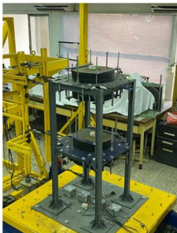
Figure 20 Le modèle sur la table vibrante avec l'instrumentation
