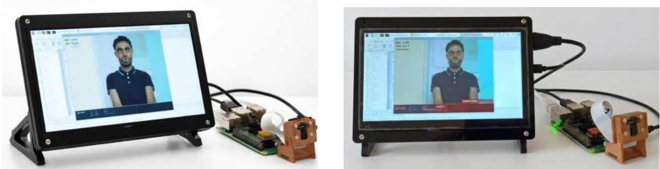
FIGURE 5.2 – Dispositif matériel du système embarqué : Raspberry Pi 4, écran TFT 7 pouces et module caméra monté sur support, exécutant l'interface de détection en temps réel.
