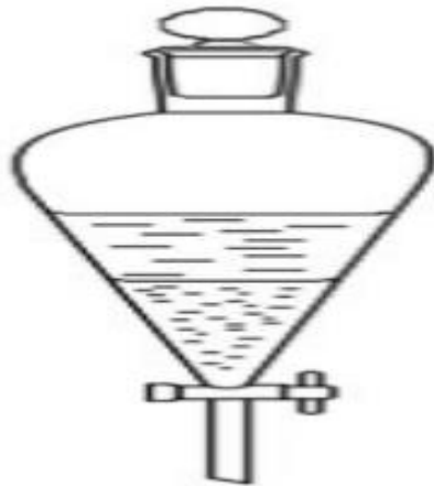
Figure 15: dessin schématique d'une ampoule de décantation avec deux couches distinctes de liquides ( Moldoveanu et David, 2015 ).
