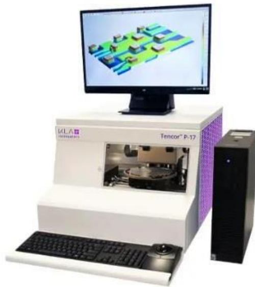
Figure 24. Le P-17 Profilomètre mécanique pour l'industrie[47].
