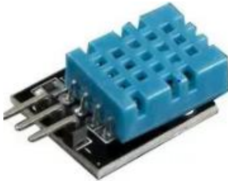
Figure 22: Capteur température et humidité. [40]
