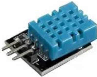
Figure 33: Module capteur température et humidité DHT11 à sortie numérique. [61]
