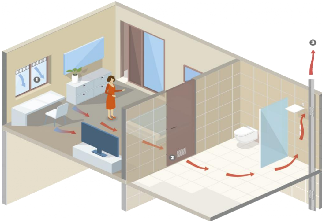
Figure 5: Système de ventilation naturelle. [18]
