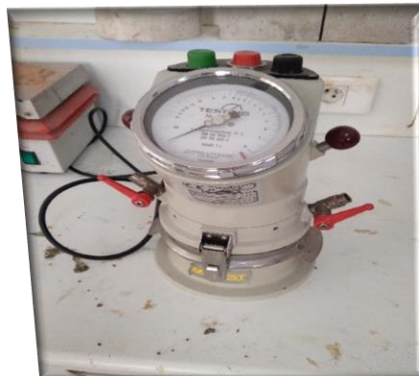
FigureII.9 : Appareil l'aéromètre à mortier ( mesure de la teneur en air).
