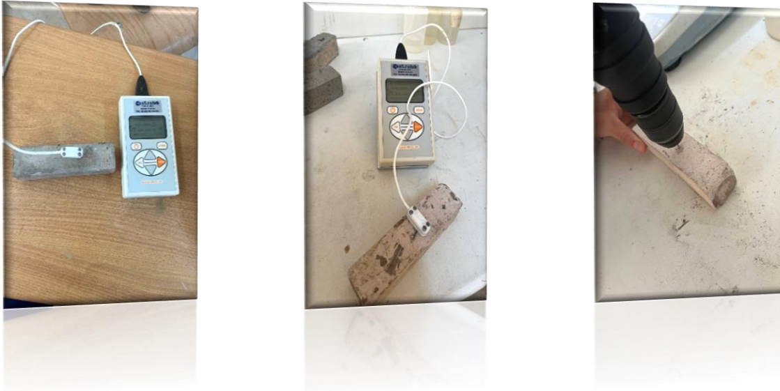
Figure II.17 : Les étapes du principe de la conductivité thermique (CT mètre).
