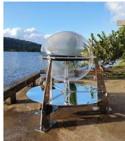
Figure 2.3 : Distillateur sphérique à balayage [34].
