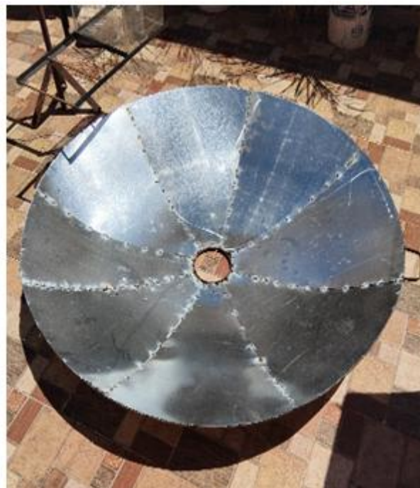
Figure 5.3 : Le réflecteur parabolique utilisé.
