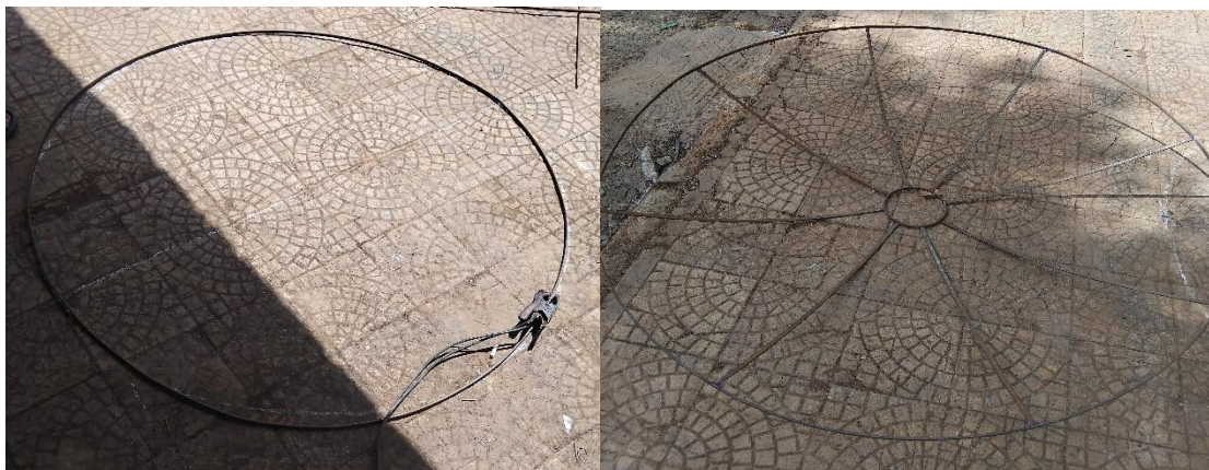
Figure 5.1 : le squelette de la parabole.
