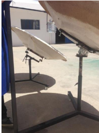
Figure 4.5 : Concentrateur solaire parabolique [85].
