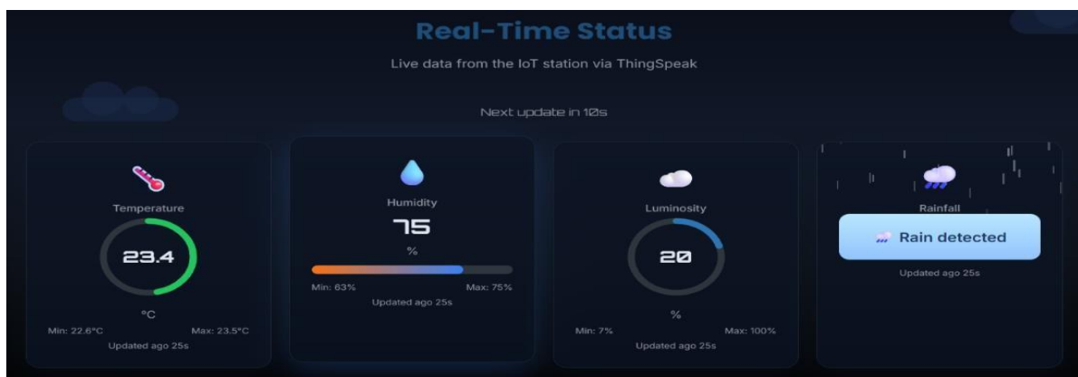
Figure 4.13 : Tableau de bord temps réel de l'interface web MeteoIoT développée (T°=23,4°C, H=75%, Lum=20%, Pluie détectée)
