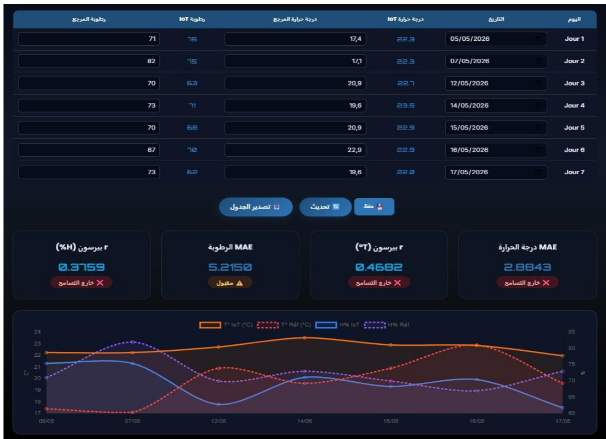
Figure 4.16 : Module de validation métrologique de l'interface Web : comparaison des mesures IoT avec les données AccuWeather et calcul automatique des indicateurs MAE et du coefficient de corrélation de Pearson.
