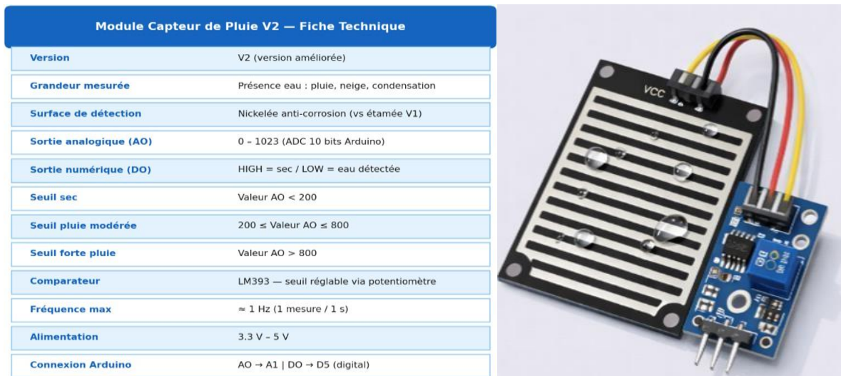
Figure 2.9 : Fiche technique (à gauche), et image (à droite) du capteur de pluie V2[25]
