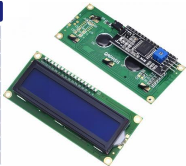
Figure 2.10 : Fiche technique (à gauche), et image (à droite) de l'afficheur LCD 1602 I2C [26]
