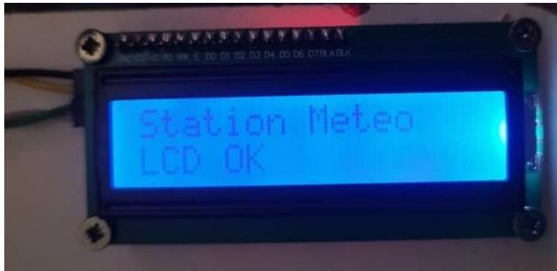
Figure 4.9 : Le message « Station météo », avec la légende «LCD ok » en dessous, bien affiché sur l'afficheur LCD 1602 I 2 C.]
