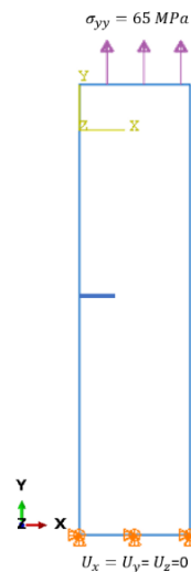
Figure 14 : Chargement uniaxial pour une plaque fissurée.
