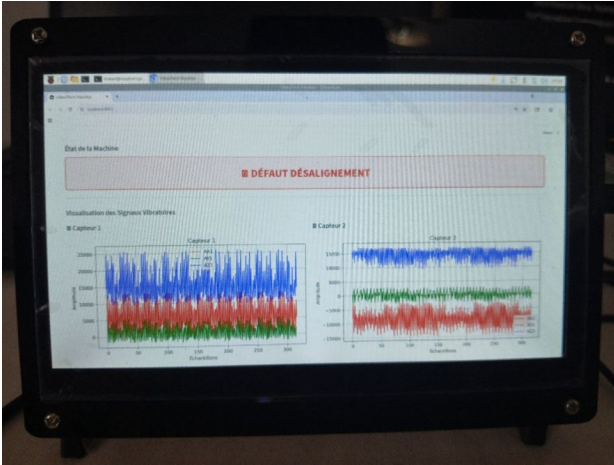
(a) Affichage des signaux vibratoires en temps réel sur l'écran Raspberry Pi
