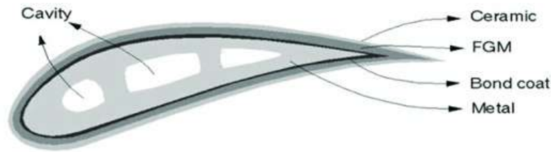
Figure 3: Section laterale d'une ailette d'une turbine
