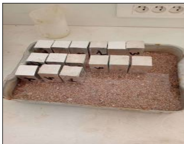
Figure 53: Absorption d'eau par capillarité
