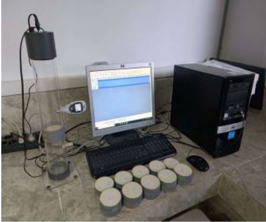
Figure 57: Appareil pour l'essai acoustique.
