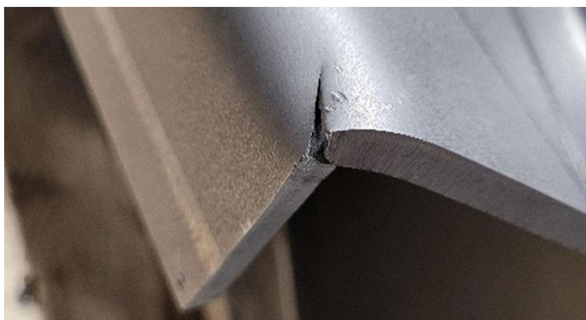
Figure 2-15: défaut de pliage.
