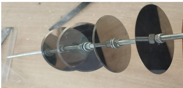
Figure 0.2 tige filetée avec des disques métalliques.
