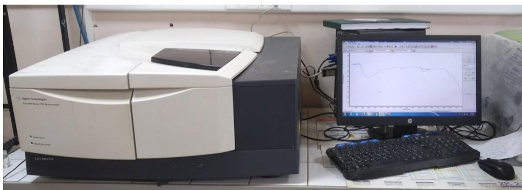
Figure 15: Procédure Appareil de spectroscopie infrarouge FTIR
