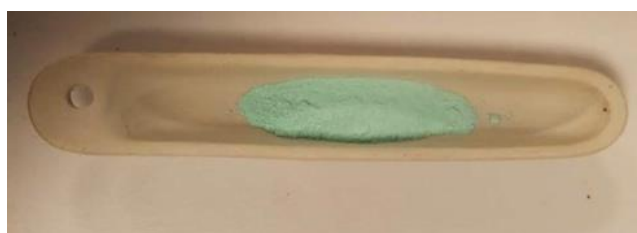
Figure 10 : NiAl dans un creuset avant calcination
