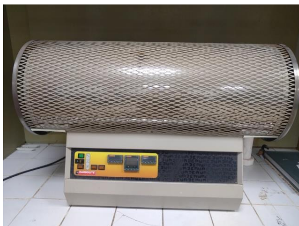
Figure 9 : Four tubulaire horizontal de laboratoire (Carbolite)
