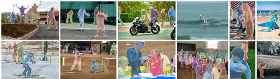
FIGURE 2.2 – Détection des points clés des personnes et segmentation à l'aide de Mask
