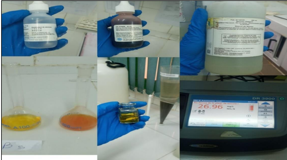
Figure II- 26 : méthode de mesuré le \text{NH}_4^+
