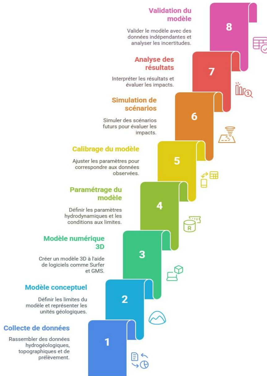
Figure 35: processus de modélisation des eaux souterraines
