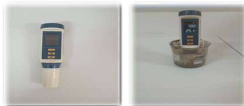
Figure 20 : Appareil multiparamètre utilisé pour la mesure du pH et de la conductivité électrique du sol
