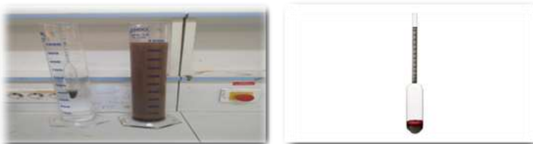
Figure 13: Analyse granulométrique du sol par sédimentation au densimètre.
