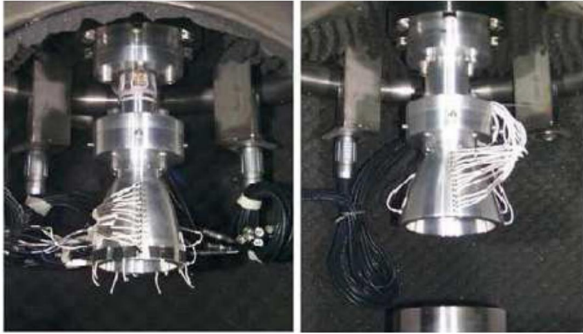
Figure 1.5 - Tuyères TIC et TOC du DLR [6].
