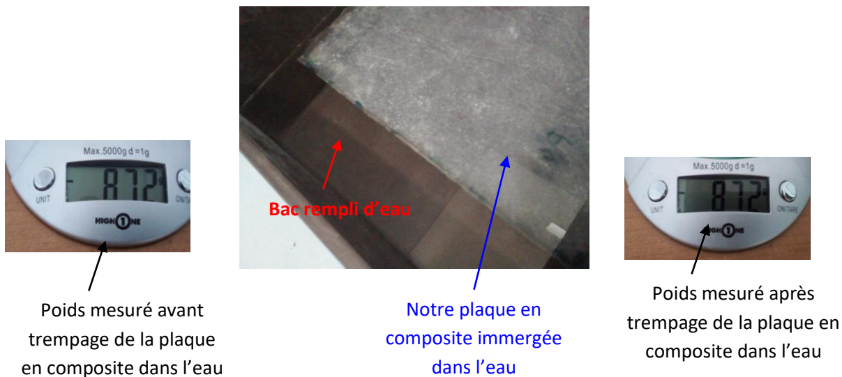
Figure 4- 2 : Test de perméabilité sur notre plaque en composite
