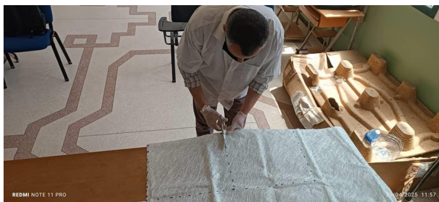
Figure 3- 5 : Découpage de la fibre de verre
