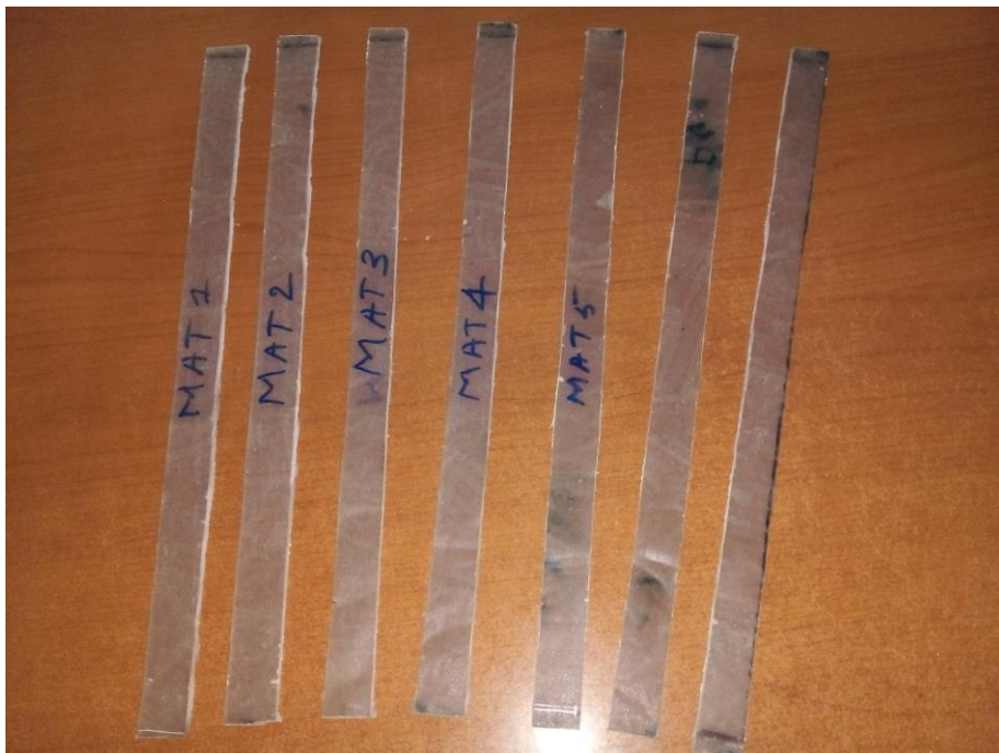
Figure 3- 14 : Le découpage des éprouvettes
