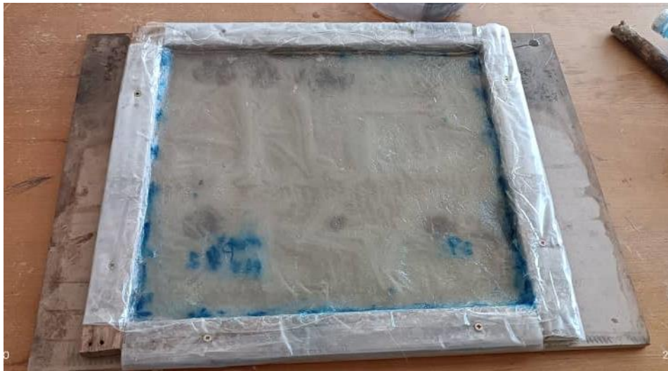
Figure 3- 10 : Le matériau composite final de 04 plis
