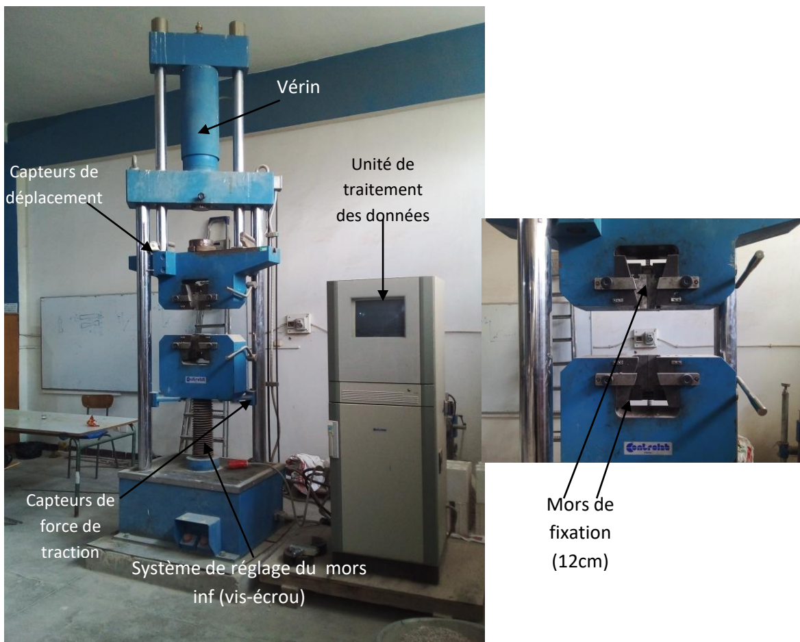
Figure 4- 5 : Machine de traction CONTROLAB modèle H0003
