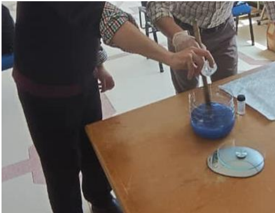
Figure 3- 8 : Mélange de la résine avec le durcisseur
