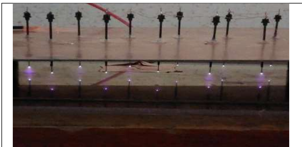
igure IV.3 : Photographie d'une décharge corona multi-pointes DC au laboratoire Pprim
