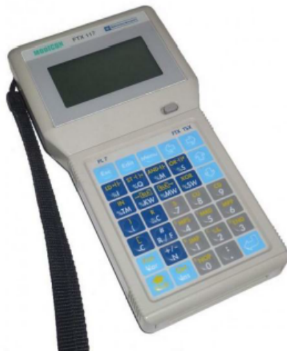
Figure I-9 : Console de programmation Télémechanique Schneider TFTX 1170 [W3].
