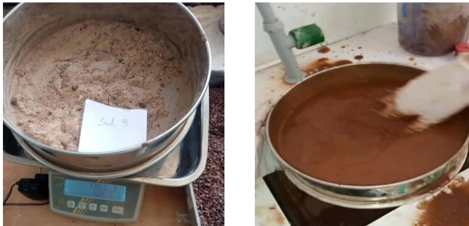
Figure 11 : Analyse de la teneur en eau d'un échantillon de sol (cliché Maamar et Miloudi, 2026)
