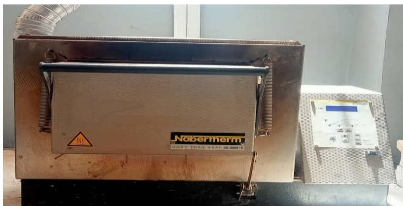
Figure 12 : séchage des échantillons de sol dans un four à moufle (cliché Miloudi et Mammar, 2026)
