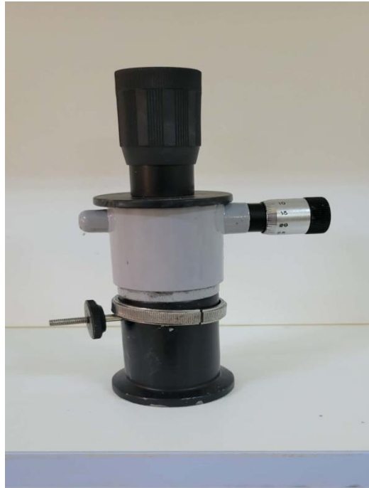
Figure 2.31 : Appareil microscope de mesure pour le suivi de la propagation des fissures.
