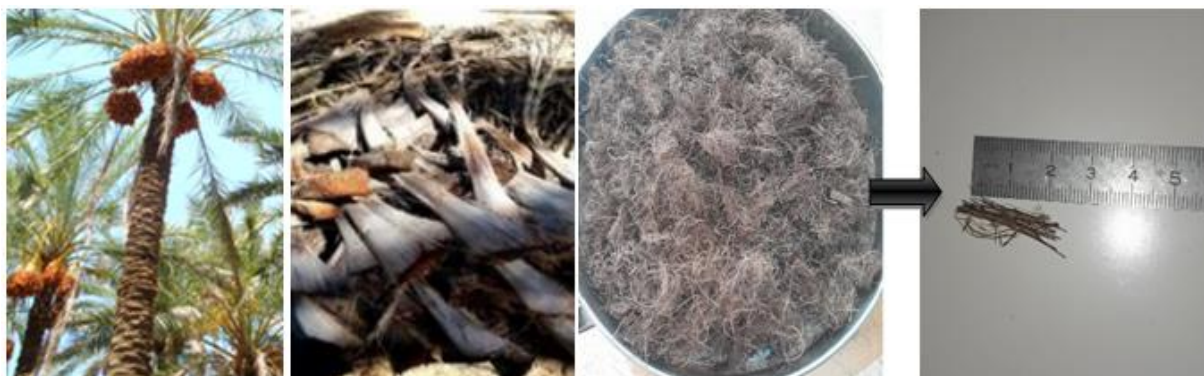
Figure 2.6 : Les étapes d'extraction des fibres du palmier dattier.
