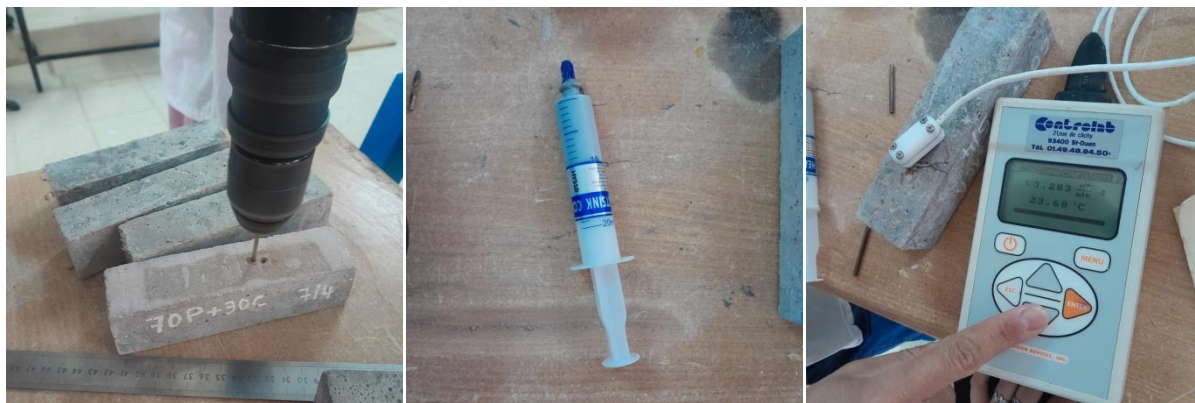
Figure 2.29 : Essai de mesure la conductivité thermique.
