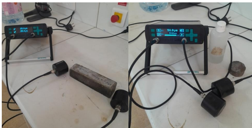
Figure 2.27 : Appareil d'auscultation sonore « Ultrason ».
