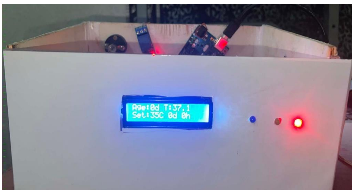
Figure III.17 : Comportement du système lors d'un dépassement de consigne (37.1°C).
