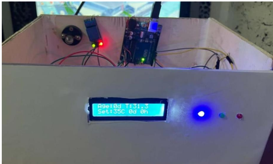
Figure III.15 : Activation du chauffage dans le système de surveillance et de contrôle de température avicole.
