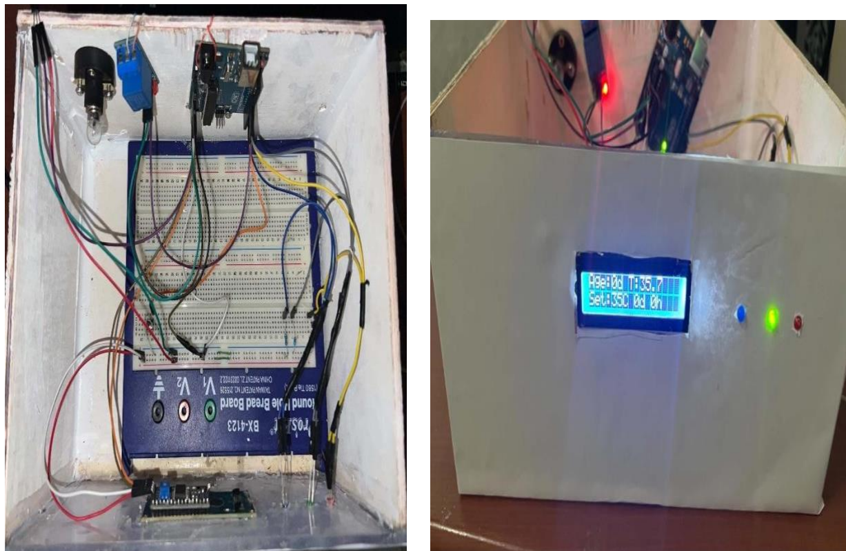
Figure III.14: Montage réel du contrôleur de température.
